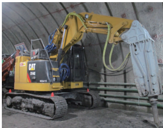
T-PROBO: トンネル工事に特化したモデルです。8t、15t、20tクラスの油圧シヨベルに対応します。
